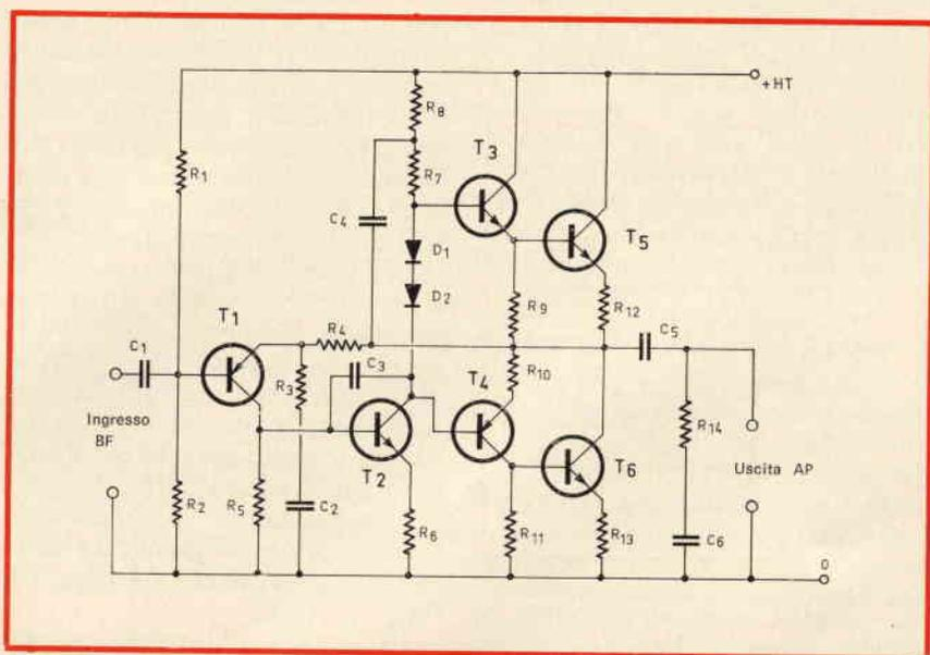
Fig. 1 - Schema classico di numerosi amplificatori BF attuali, dove si riconosce in C<sub>3</sub>, l'abituale ausiliario che assicura la stabilità del montaggio in presenza di controreazione, la cui percentuale è determinata alle frequenze udibili da R<sub>4</sub>, R<sub>3</sub> e C<sub>3</sub>.
