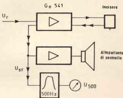
Fig. 7 - Schema a blocchi del circuito di misura.
