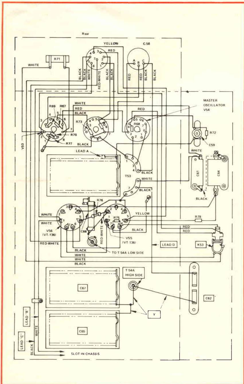
Fig. 5 - Lato inferiore del trasmettitore tipo T-20/ARC-5, prima della conversione.
