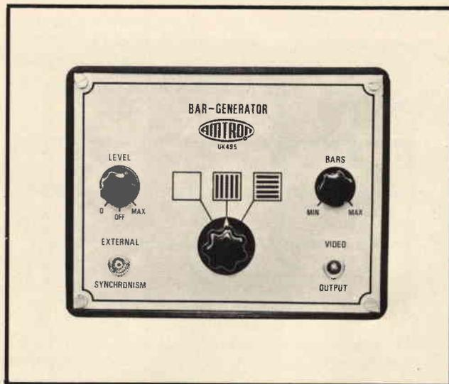
Fig. 1 - Generatore di barre AMTRON UK 495/C, fornito in scatola di montaggio dalla G.B.C. Italiana.
