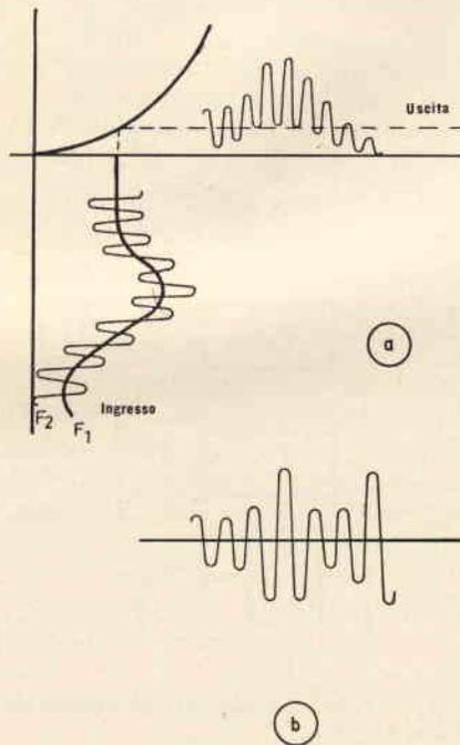
Fig. 5 - a) Comportamento di una caratteristica di trasferimento non lineare, in presenza di un segnale composto; b) segnale composto filtrato da un filtro di banda.
