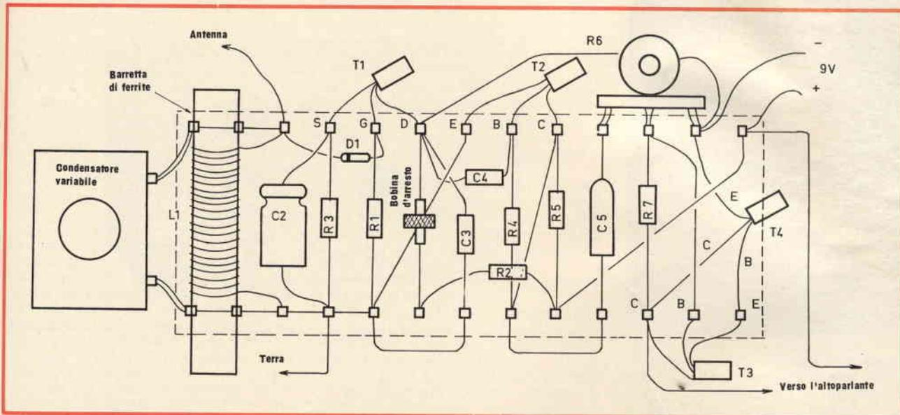
Fig. 6 - Cablaggio del ricevitore il cui schema elettrico è visibile in figura 5.
