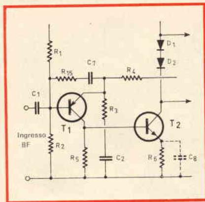
Fig. 3 - Circuito correttore proposto dal Sig. Otala. E' ugualmente consigliato di shuntare, con un condensatore di valore sufficientemente elevato, il resistore di emettitore di  $T_2$ , nel caso esso introducesse una non trascurabile controreazione locale.
