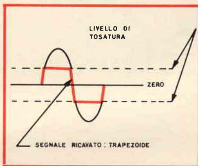
Fig. 1/b - Segnale risultante impiegando lo schema di figura 1.
