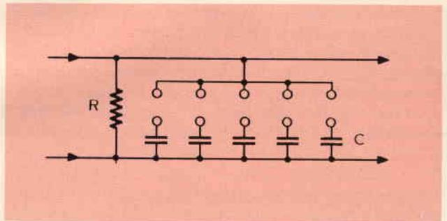
Fig. 16 - Dispositivo per la regolazione di tono realizzato con condensatori.
