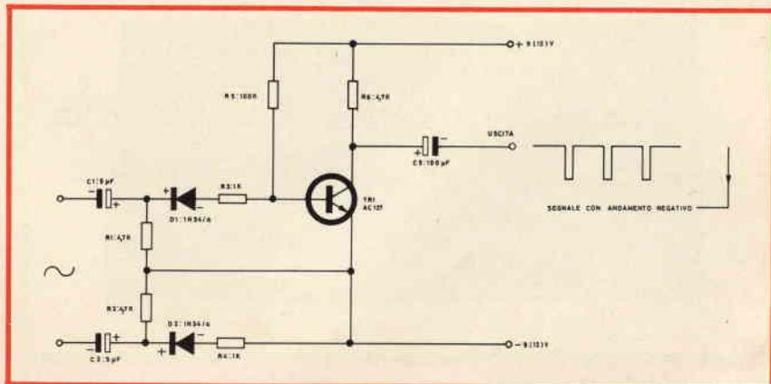
Fig. 2 - Schema elettrico dello squadratore di segnali con andamento negativo.
