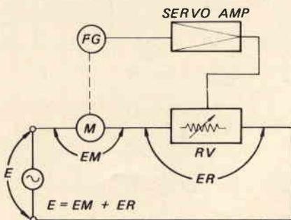
Fig. 1 - Principio del servo-sistema in c.a.
