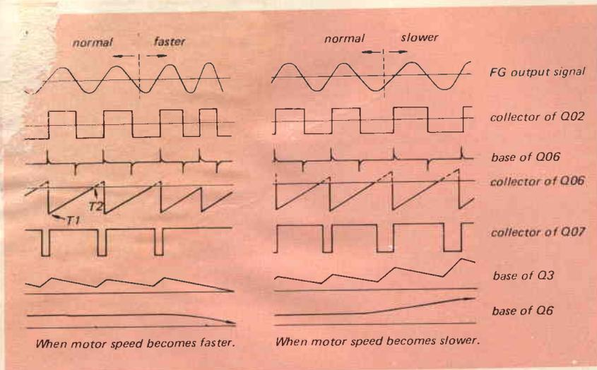
Fig. 3 - Forme d'onda di controllo del circuito di servo.
