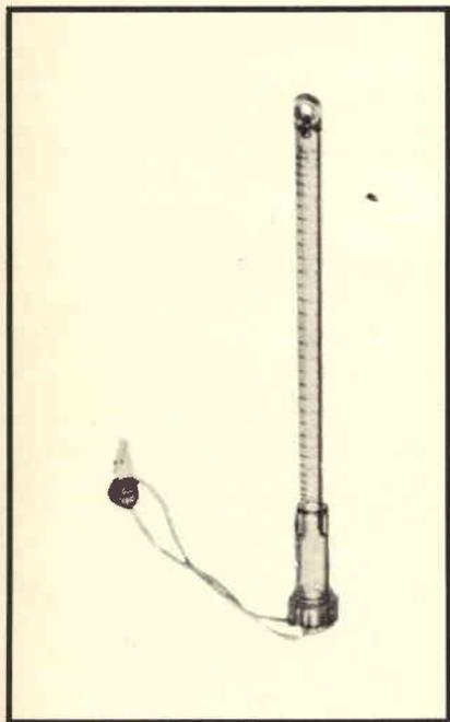
Fig. 4 - Indicatore di velocità per gommoni e piccole imbarcazioni, di tipo portatile (Finder).
