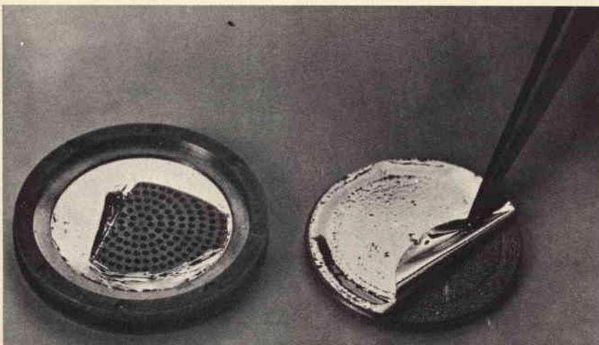
Se non è montato su di un anello supporto, l'elettreto rappresentato a destra è delicato da maneggiare. Lo si vede, a sinistra, mantenuto tra questo anello e la piastra di base a fori, lo strato d'oro è al di sotto. La pellicola è stata strappata per meglio rivelare la costituzione dell'insieme.
