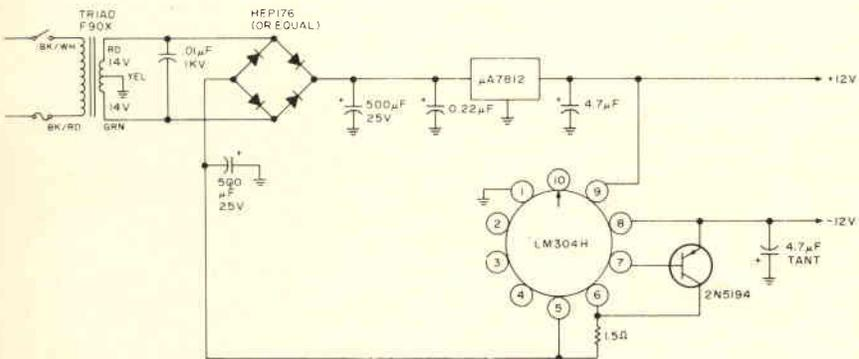
Fig. 22 - Schema completo dell'alimentatore usato per il circuito di figura 21, in grado di fornire due tensioni simmetriche continue di uscita, entrambe del valore di 12 V, ma di polarità opposta rispetto a massa.
