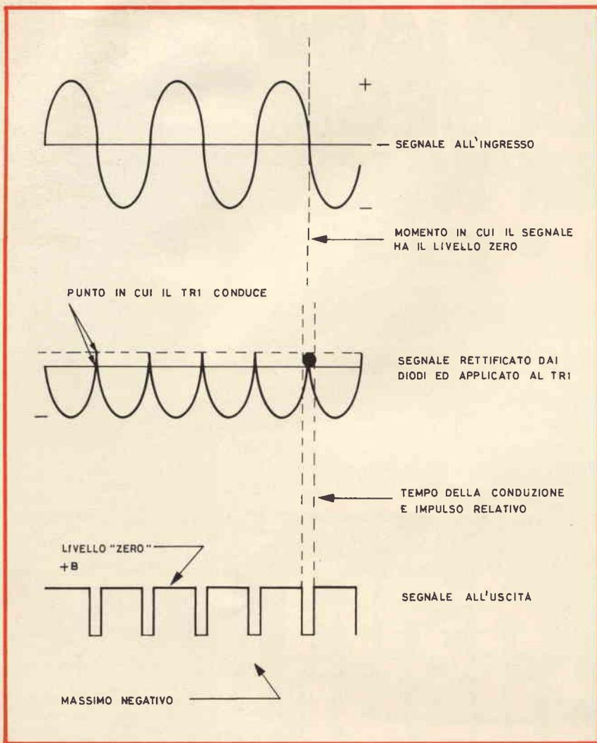
Fig. 3 - Funzione del circuito, le forme d'onda sono riferite al circuito di figura 2. Per il circuito di figura 4 dovrebbero essere invertite.
