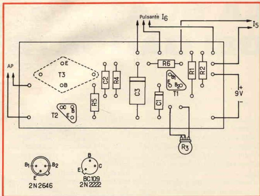
Fig. 2 - Disposizione dei componenti sulla piastra e vista dei terminali dei transistori impiegati.
