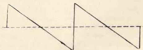
Fig. 3 - Corrente che attraversa le bobine di deflessione di quadro avente perfetta forma a dente di sega.
