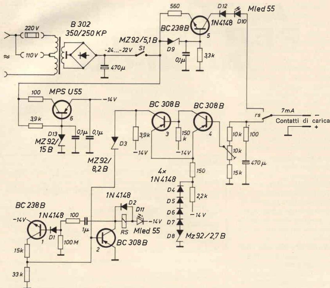
Fig. 1 - Apparecchiatura di carica per elementi al Nichel-Cadmio con controllo periodico automatico dello stato di carica. Per segnalazione servono i due diodi a luminescenza D10 e D11.
