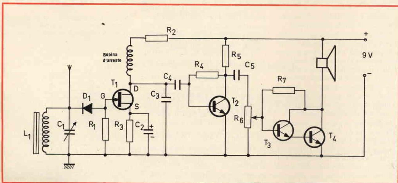
Fig. 5 - Circuito di un ricevitore adatto per l'ascolto in altoparlante.
