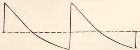
Fig. 4 - Corrente che attraversa le bobine di deflessione di quadro di forma anomala che dà luogo all'inconveniente illustrato in figura 2.
