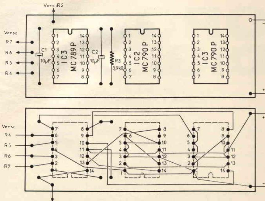
Fig. 2 - Montaggio e disposizione dei componenti.
