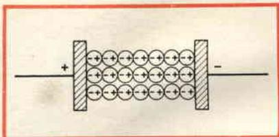
Fig. 2 - Quando si applica una elevata tensione continua a due elettrodi separati per mezzo di un dielettrico solido, le molecole di questo, riunite in riposo in maniera disordinata, formano una catena nel senso delle linee di forza del campo. Esse sono polarizzate ed immagazzinano una carica elettrica.
