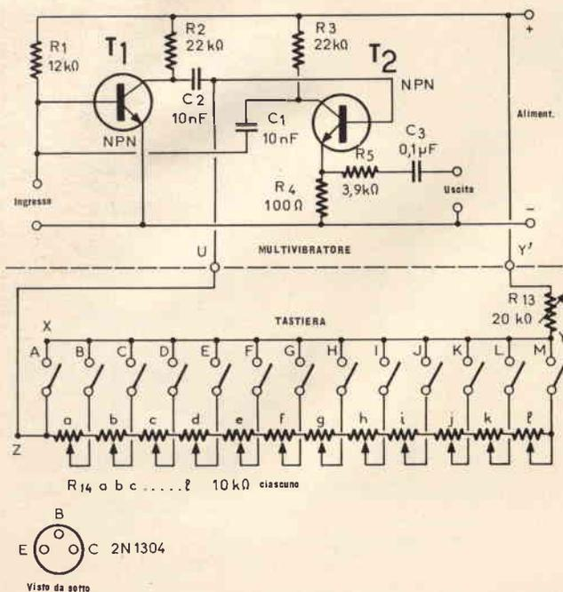
Fig. 18 - Schema elettrico del generatore di note. I potenziometri sono da 10 kΩ ciascuno.
