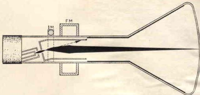
Fig. 8 - Cannone elettronico di un tubo RC montato con un certo angolo rispetto all'asse del collo del tubo per evitare i danni provocati dagli ioni.
