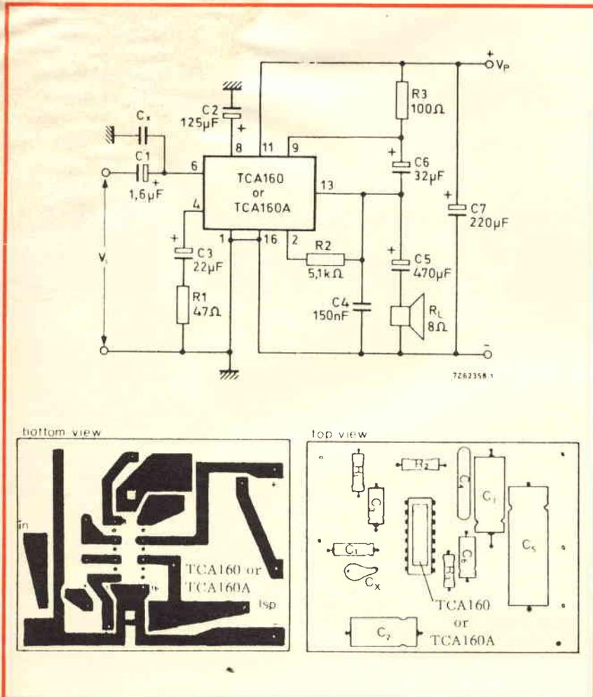
Fig. 9 - Schema elettrico e di montaggio di un amplificatore BF da 2 W realizzabile con il circuito integrato Philips TCA160Q.
