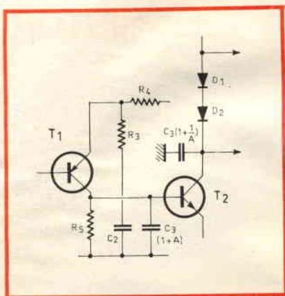
Fig. 2 - Rappresentazione equivalente dei ruoli assunti dal condensatore  $C_3$ , tenendo conto dell'effetto Miller.
