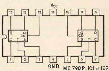
Fig. 5 - Disposizione dei terminali del circuito integrato MC790P.
