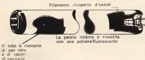
Fig. 3 - Sezione di un tubo per la produzione di luce nera.
