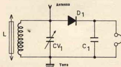
Fig. 1 - Semplice circuito di un ricevitore per ascolto in cuffia. In pratica è un miglioramento della vecchia radio a galena.
