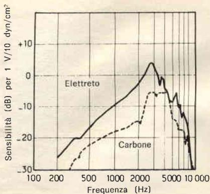
Fig. 8 - Paragonando le curve di un microfono a elettreto e di uno a carbone si può constatare che ad uguaglianza di eccitazione, il primo fornisce, fino a più di 7.000 Hz, una tensione superiore a quella del secondo. Si noterà che 10 dyn/cm<sup>2</sup> corrispondono a 1 Pa (Unità internazionale) o a 10 mgf/cm<sup>2</sup> (vecchia unità).
