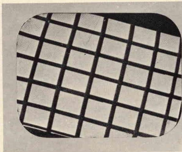
Fig. 6 - Immagine inclinata, a causa dello spostamento delle bobine di deflessione.
