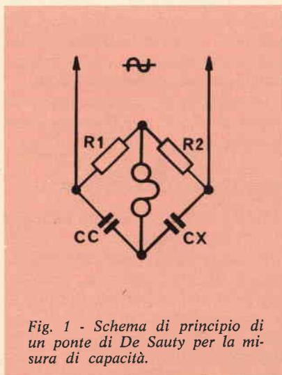
Fig. 1 - Schema di principio di un ponte di De Sauty per la misura di capacità.
