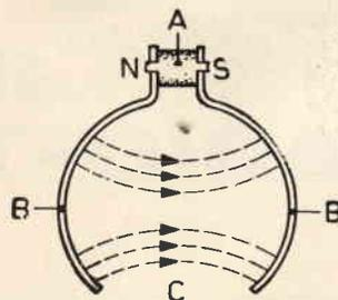
Fig. 9 - Vista frontale di un magnete per trappola ionica.
