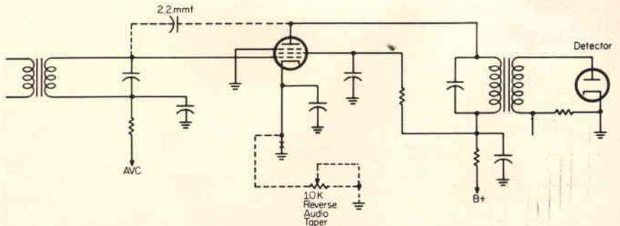
Fig. 1 - Esempio di modifiche da apportare all'ultimo stadio dell'amplificatore di media frequenza di un ricevitore supereterodina, per migliorare la selettività e la stabilità di funzionamento.
