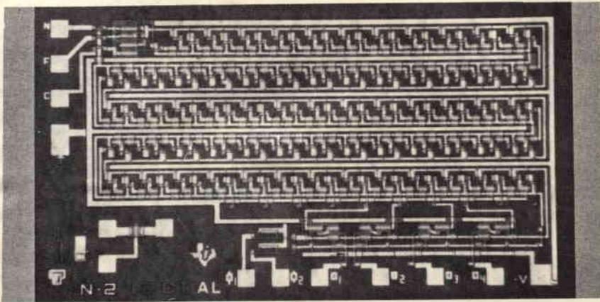
Fig. 3 - Registro a decalaggio su circuito integrato utilizzando dei transistori MOS; piastrina di 2,5 x 1,5 mm.
