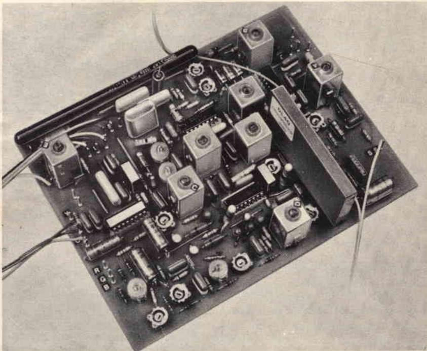
Fig. 2 - Prototipo di laboratorio del decodificatore SECAM e PAL/SECAM.
