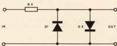
Fig. 1 - Schema di base dello squadratore di segnali.
