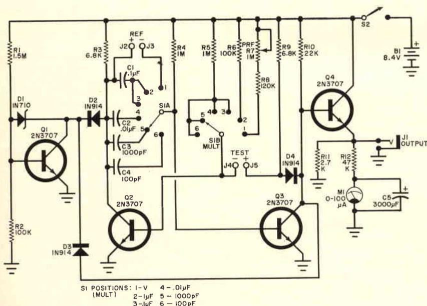
Fig. 17 - Schema elettrico completo del capacimetro a lettura diretta, in grado di misurare valori capacitivi compresi tra un minimo di 15 pF ed un massimo di 10 µF, in cinque portate. Il circuito può essere completato per consentire la misura di valori capacitivi fino a 100 µF.
