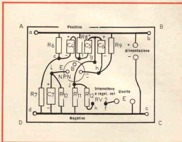
Fig. 20 - Schema di cablaggio del vibrato.
