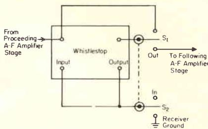
Fig. 4 - Metodo di inserimento e disinserimento del filtro di cui si è detto, con l'aiuto di un doppio deviatore.
