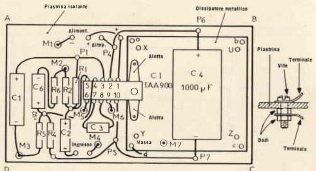
Fig. 17 - Schema di cablaggio dell'alimentatore realizzato con il circuito integrato TAA900 (visto da sopra). Nel particolare a destra è indicato il sistema di fissaggio dei terminali di collegamento.
