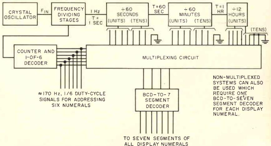
Fig. 16 - Schema a blocchi di un altro tipo di orologio elettronico da polso, impiegante un sistema «multiplex», per ottenere la riproduzione numerica dell'orario.
