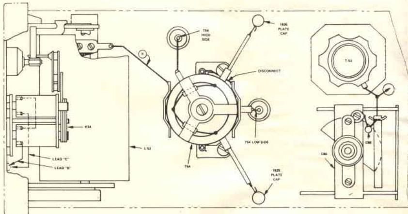
Fig. 6 - Lato superiore del trasmettitore tipo T-20/ARC-5, che è stato tracciato in modo tale da mettere in evidenza la posizione dei componenti più importanti relativi alla modifica dell'oscillatore a frequenza variabile. Lo schermo può coprire i circuiti sintonizzati del VFO.
