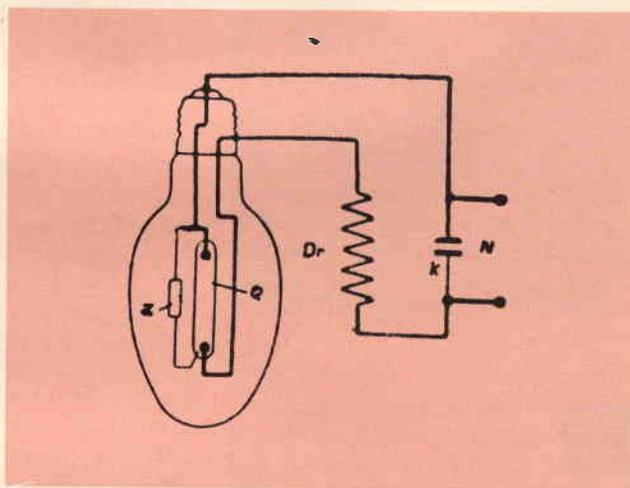
Fig. 5 - Schema di principio di una lampada fluorescente a palloncino. Q = bruciatore a mercurio. Z = Resistenza di accensione. Dr = Induttanza da 220 - 240 V (eventuale trasformatore per 120 V). K = Condensatore di compensazione. N = Rete.
