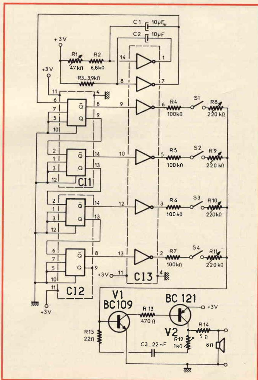
Fig. 1 - Schema elettrico dell'organo digitale presentato in questo articolo.
