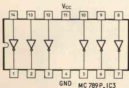
Fig. 4 - Disposizione dei terminali del circuito integrato MC789P.
