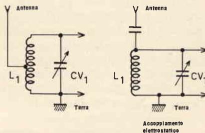
Fig. 2 - Due sistemi diversi di accoppiamento. La soluzione consiste nell'impiego di un condensatore fisso o variabile.
