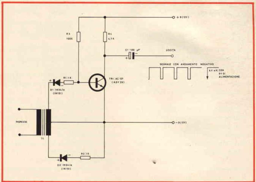
Fig. 5 - Schema elettrico completato con l'aggiunta di un trasformatore.
