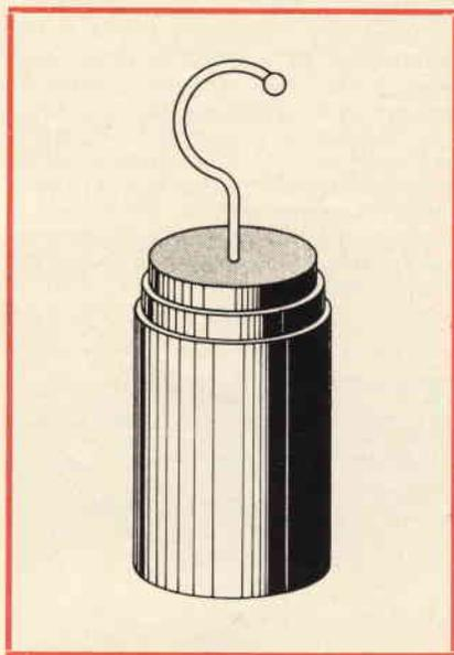
Fig. 1 - La bottiglia smontabile di Leyde era costituita da due cilindri di ottone, separati da un recipiente di vetro. La si caricava collegando l'asticella del cilindro interno ed il cilindro esterno ad un generatore di alta tensione continua. Se si separavano, si cortocircuitavano i due cilindri, se ne rimontava l'insieme e si collegavano i suoi elettrodi ad un elettrometro, questo rivelava che il vetro aveva conservato una carica elettrica.
