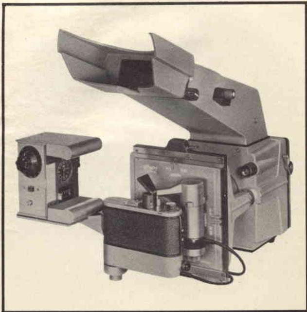
*Robot con apparecchiatura per fotografare gli oscillogrammi.*
