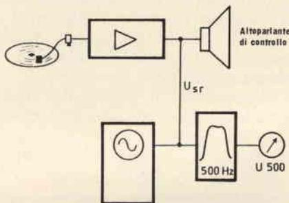
Fig. 8 - Schema dell'installazione sulla quale viene riprodotto il disco inciso.
