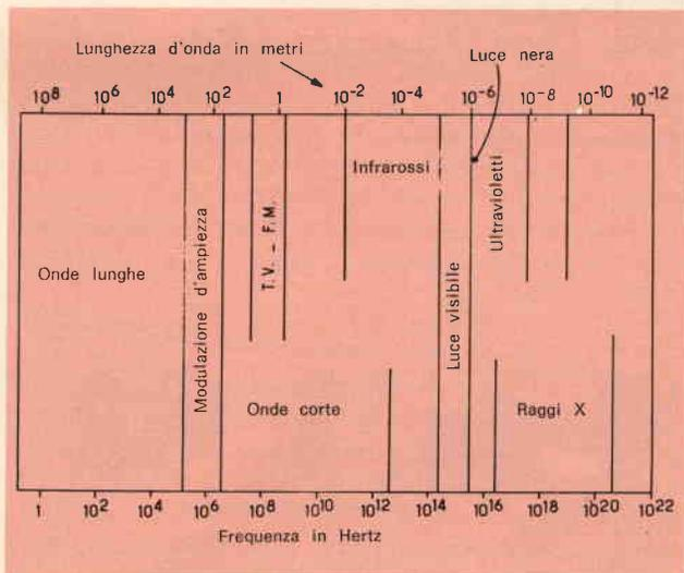
Fig. 1 - Scala di radiazione, dove sono situati i differenti spettri.
