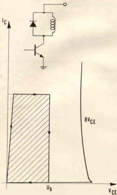
Fig. 3 - Metodo di protezione che si avvale di un diodo connesso in parallelo al carico.
