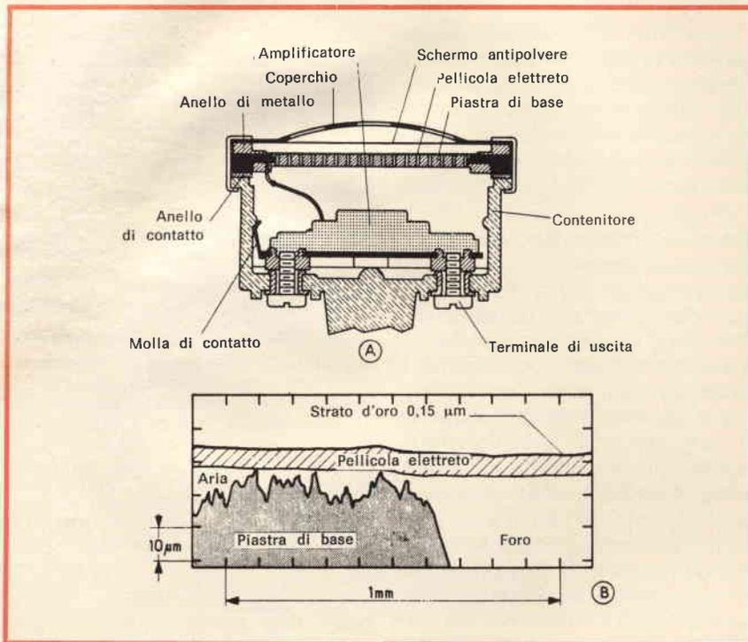
Fig. 6 - In questo spaccato di microfono a elettreto montato in una cornetta telefonica, si vede che la pellicola di dielettrico caricato — o elettreto — è in contatto con una piastra di base rugosa, provvista di fori, che costituisce l'elettrodo collegato all'amplificatore. Il lato metallizzato della pellicola è collegato alla massa (A). La sezione B mostra che le rugosità della piastra di base provocano la presenza di uno strato d'aria tra essa ed il lato non metallizzato della pellicola.
