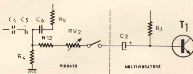
Fig 11 - Circuito di collegamento del vibrato al multivibratore.
