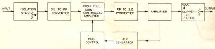
Fig. 19 - Schema a blocchi del dispositivo con cui si può migliorare il funzionamento dei rice-trasmettitori nei confronti della gamma di frequenze interessante la sola voce umana.
