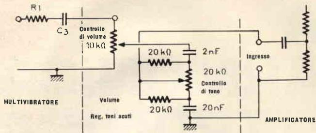
Fig. 12 - Circuito di controllo di volume e di tono semplificato.
