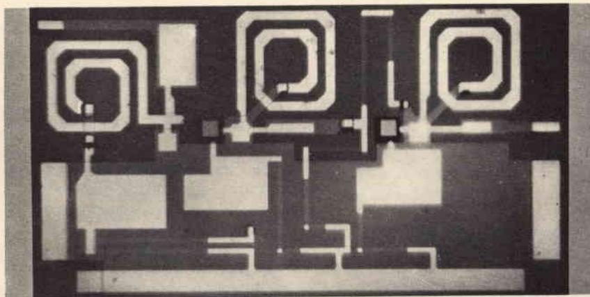
Fig. 4 - Amplificatore 500 MHz integrato; piastrina di 7,1 x 3,8 mm.
