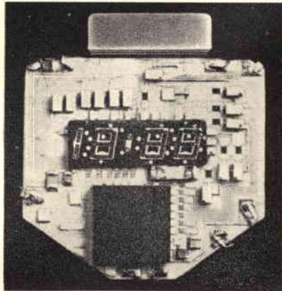
Fig. 15 - Struttura interna dell'orologio elettronico a lettura diretta di cui alla figura 14: al centro è visibile l'unità per la riproduzione numerica.
