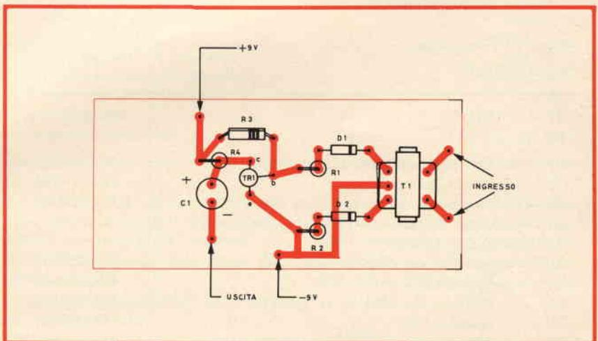
Fig. 6 - Piano di montaggio del circuito presentato in fig. 5. Le misure possono essere di 70 x 35 mm.
