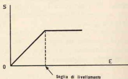
Fig. 3 - Caratteristica di trasferimento di un amplificatore moderno.
