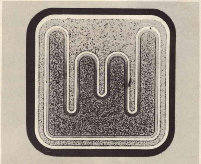
Sono stati recentemente introdotti sul mercato i transistori di potenza al silicio con base « epitassiale ». Secondo questa nuova tecnica, la base sulla quale verrà poi diffuso, in una fase successiva l'emettitore viene fatta crescere sul substrato (collettore) impiegando il processo epitassiale. Questo processo può essere facilmente tenuto sotto controllo e può essere usato per la
