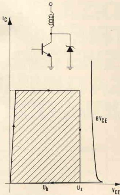
Fig. 4 - Altro sistema di protezione impiegante diodo a valanga a forte capacità di dissipazione.
