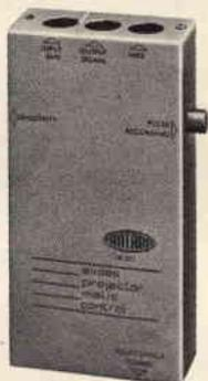
L'UK 871 permette di effettuare, oltre al comando a distanza del proiettore, il commento sonoro e vocale delle diapositive, con perfetto sincronismo. Questo dispositivo ha la particolarità di disporre di un oscillatore di bassa frequenza incorporato e, in tal modo, costituisce un'apparecchiatura completa ed indipendente.
