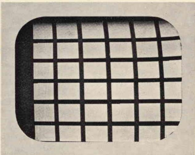
Fig. 7 - Immagine non centrata, a causa dello spostamento dell'anello di centratura.
