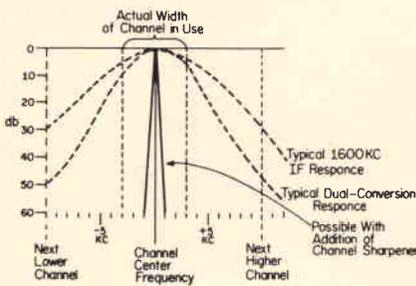
Fig. 2 - Grafico illustrante il variare dell'andamento della curva di selettività, rispetto alla frequenza centrale del canale di sintonia, con l'aggiunta delle modifiche citate a proposito della figura 1.
