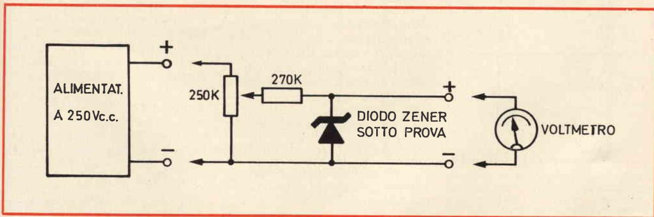
Fig. 1 - Semplice metodo per determinare il valore approssimato della tensione zener, in un diodo di questo tipo avente caratteristiche incognite. Lo strumento può essere un multimetro ad alta resistenza interna, oppure un voltmetro elettronico.
