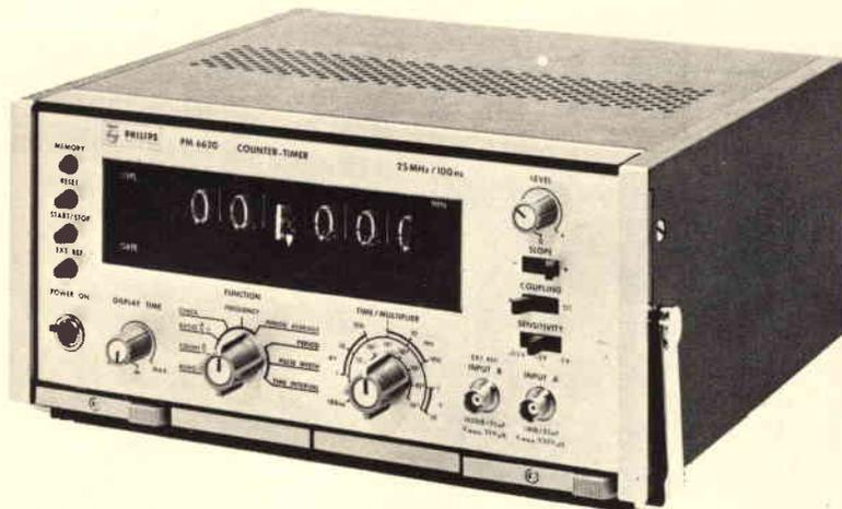
Fig. 8 - Contatore temporizzatore PM 6620 con campo di frequenza della c.c. a 45 MHz.
