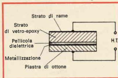
Fig. 4 - Una pellicola sottile di dielettrico, metallizzata su di un lato, è posta su di una piastra di ottone che costituisce un elettrodo. Sull'altro lato, non metallizzato, è posta una piastra di vetro-epoxy per circuito stampato il cui strato di rame costituisce il secondo elettrodo. Dopo l'applicazione, e poi la soppressione, di una tensione continua elevata agli elettrodi, si constatò che il dielettrico ha immagazzinato una carica elettrica, che persiste nel tempo.
