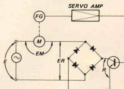
Fig. 2 - Schema pratico del servo-sistema in c.a.
