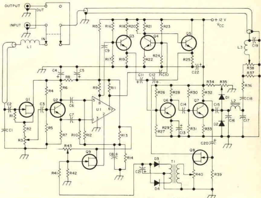
Fig. 20 - Schema elettrico completo dell'elaboratore per il canale di modulazione di cui è detto nell'articolo.
