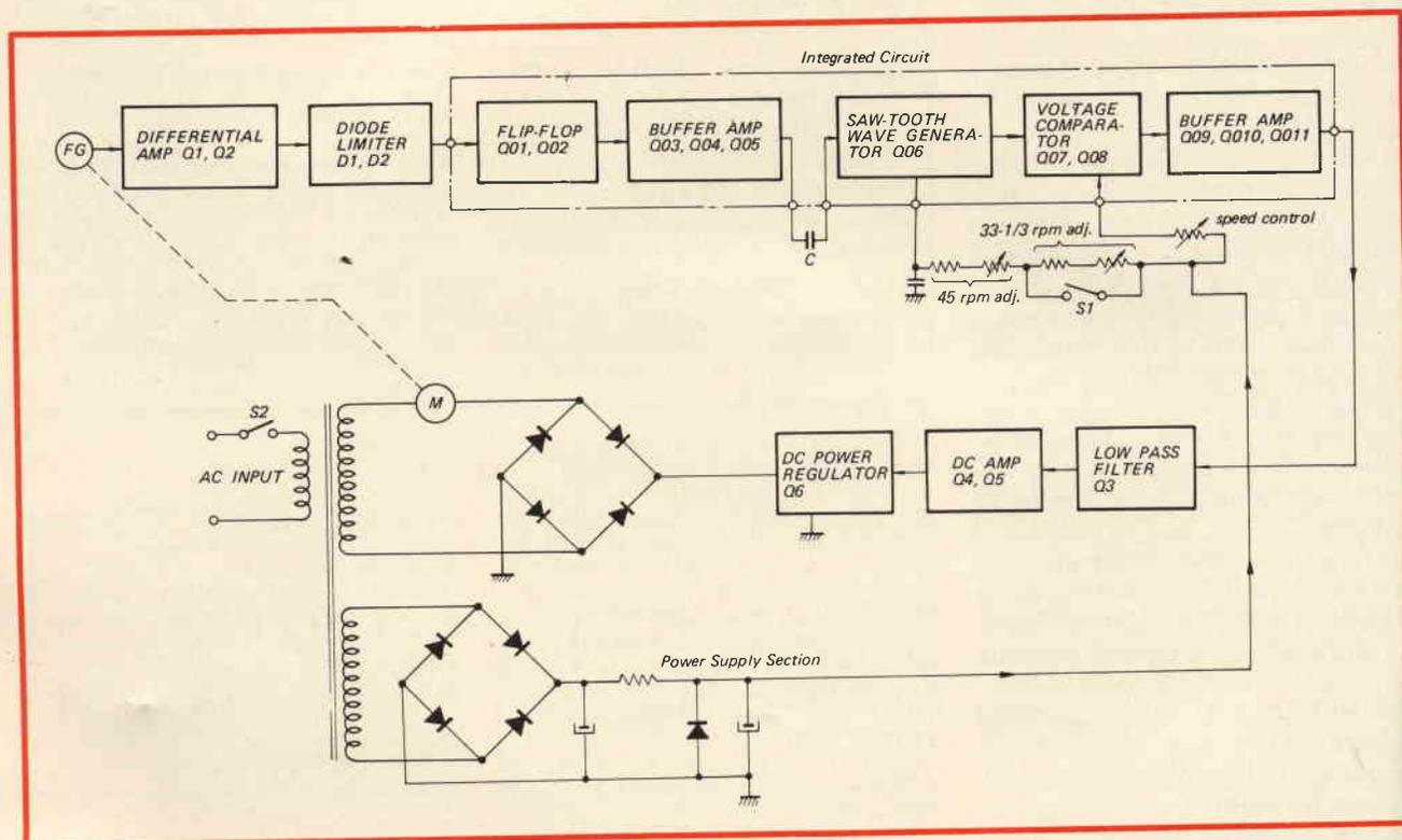
Fig. 4 - Schema a blocchi.
