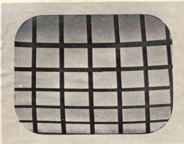
Fig. 2 - Immagine sensibilmente distorta a causa di un certo schiacciamento verso il basso ed allungamento verso l'alto.
