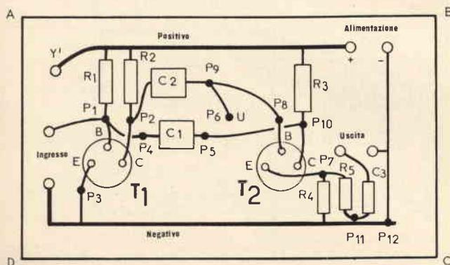
Fig. 19 - Schema di cablaggio del generatore di note.
