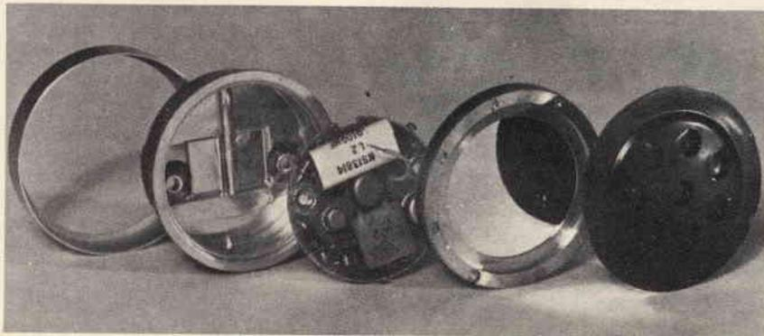
Pezzi che costituiscono un microfono a elettreto: da destra a sinistra, il coperchio, l'elettreto montato (la cui metallizzazione riflette parzialmente l'immagine del coperchio), la piastrina che regge l'amplificatore, il contenitore e l'anello di fissaggio.
