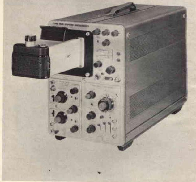
*Apparecchiatura Robot e sistema Polaroid per fotografie di oscillogrammi con finestra per l'osservazione diretta dello oscillografo.*
