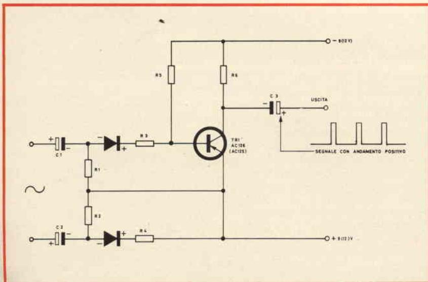
Fig. 4 - Schema elettrico dello squadratore di segnali con andamento positivo. Tutti i valori non indicati sono identici a quelli del circuito di figura 2.
