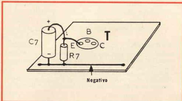
Fig. 21 - Esempio di cablaggio di componenti posti perpendicolarmente alla piastrina.
