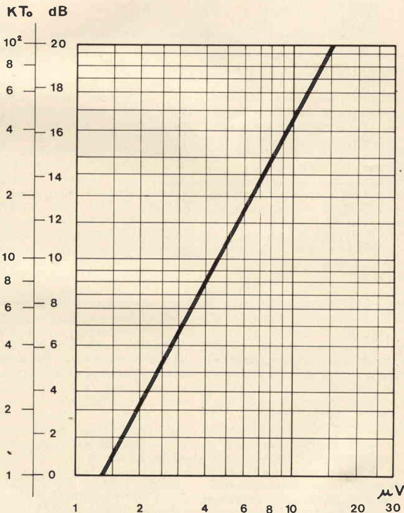
Fig. 1 - Grafico dei valori della sensibilità limite per  $S/N = 1$  (cioè rapporto segnale/disturbo = 1). Impedenza  $Z = 75 \Omega$ . I valori in  $\mu V$  sono per un circuito chiuso su una stessa impedenza mentre con il circuito aperto i valori si raddoppiano. Banda passante 5 MHz.
