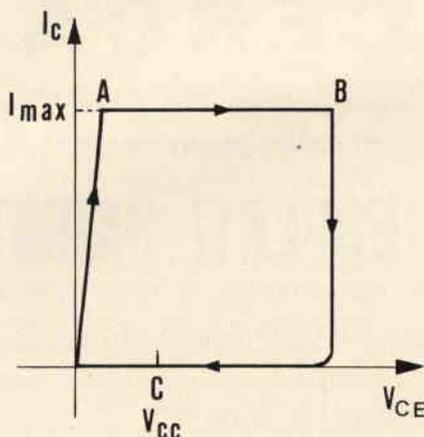
Fig. 2 - Ciclogramma tensione-corrente  $I_C/V_{CE}$ .
