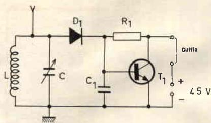
Fig. 4 - Ricevitore con uno stadio di amplificazione.
