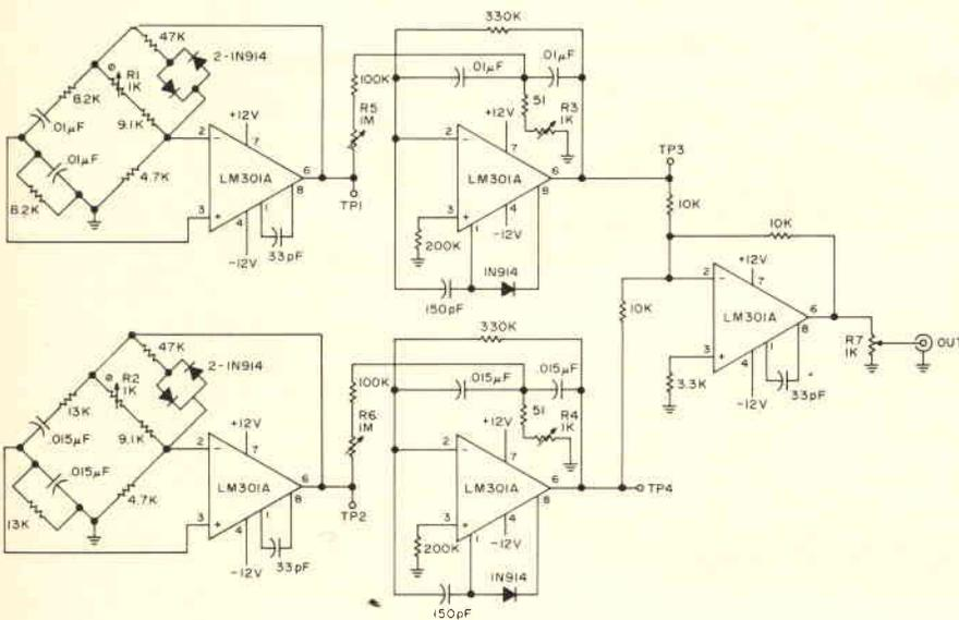
Fig. 21 - Circuito elettrico del generatore bi-tonale, mediante il quale viene facilitata la prova delle apparecchiature rice-trasmettenti, funzionanti in SSB.
