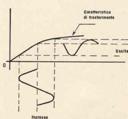
Fig. 2 - Caratteristica di trasferimento non lineare.
