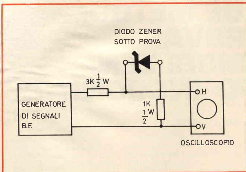
Fig. 2 - Questo secondo schema illustra un metodo assai più preciso e rapido col quale è possibile determinare le caratteristiche di un diodo normale, e stabilire anche il valore tipico della tensione zener di questo tipo. Occorre disporre a tale scopo di un generatore di segnali a bassa frequenza, e di un oscilloscopio.
