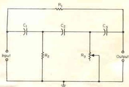
Fig. 3 - Circuito selettivo a doppio «T», che è possibile inserire lungo il percorso del segnale durante la ricezione.
