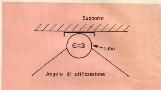
Fig. 4 - Tubo visto in sezione sul suo supporto. Considerando l'angolo che sarà utilizzato, in una camera normale, ci si accorge che quasi i tre quarti della radiazione sono sciupati. E' questo uno dei maggiori inconvenienti di questo dispositivo.
