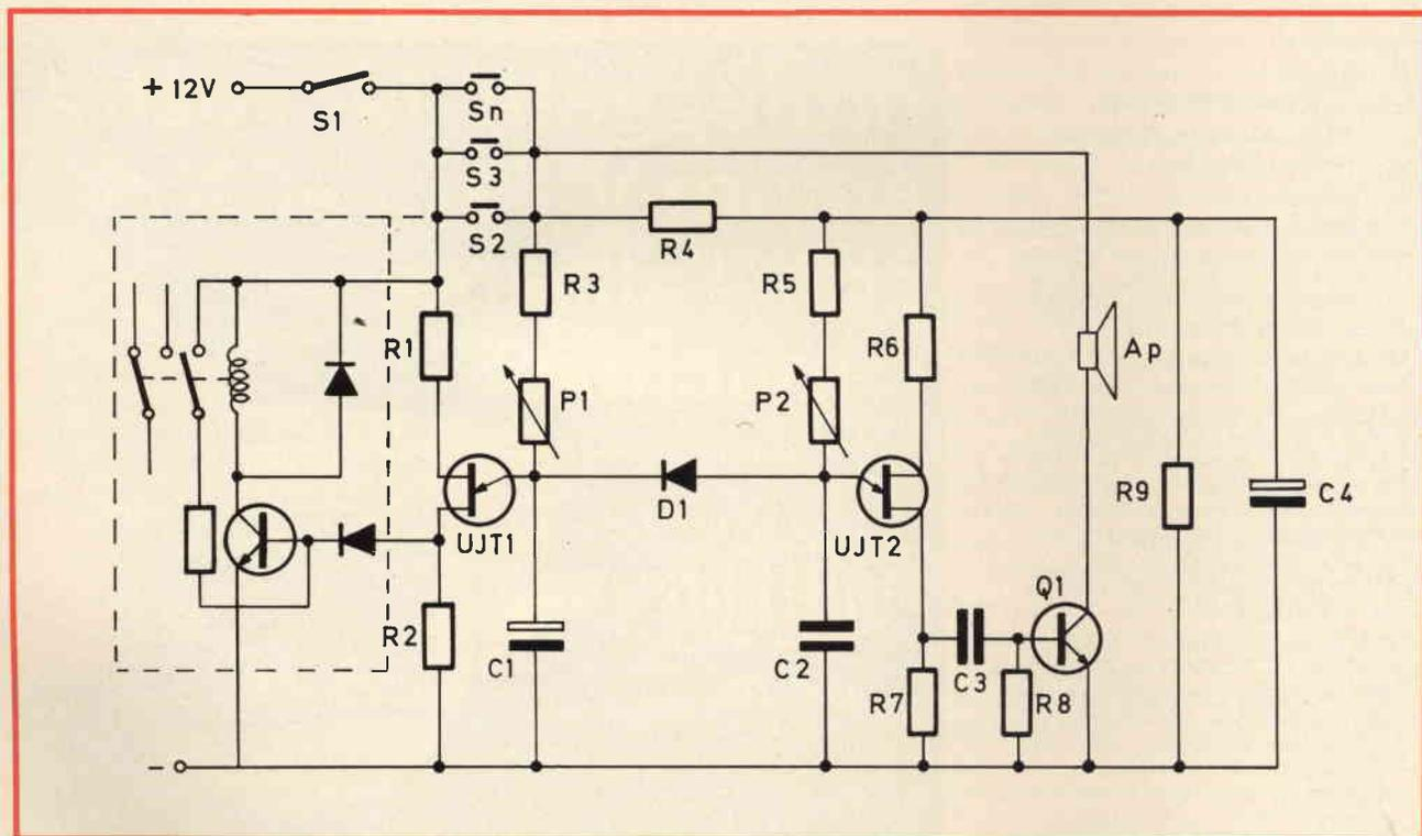
Fig. 1 - Il circuito racchiuso nel tratteggio rappresenta un dispositivo per l'alimentazione automatica di un amplificatore di potenza od altri servomeccanismi. Il transistor è del tipo 2N1711, i diodi sono BY127, il resistore ha un valore di 10 k $\Omega$  ed il relè è del tipo 12V - 2 scambi - 2A.
