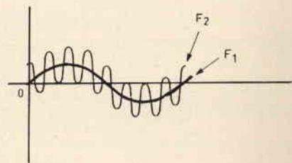
Fig. 4 - Segnali di alta e bassa frequenza miscelati.
