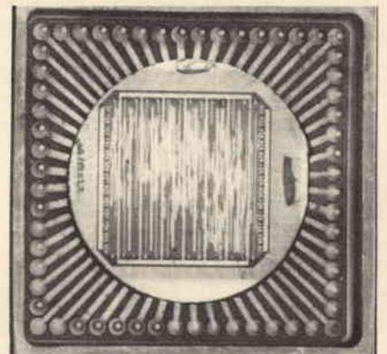
Fig. 6 - Circuito integrato su vasta scala dopo il montaggio; diametro della piastrina 32 mm.
