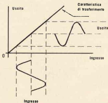
Fig. 1 - Caratteristica di trasferimento lineare.
