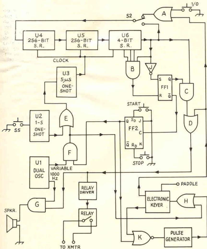
Fig. 12 - Schema a blocchi del manipolatore a memoria tipo WA1BYM.
