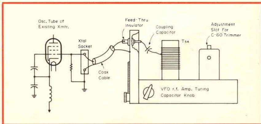
Fig. 7 - Metodo pratico per ottenere l'accoppiamento del VFO rispetto all'oscillatore a cristallo facente parte del trasmettitore.
