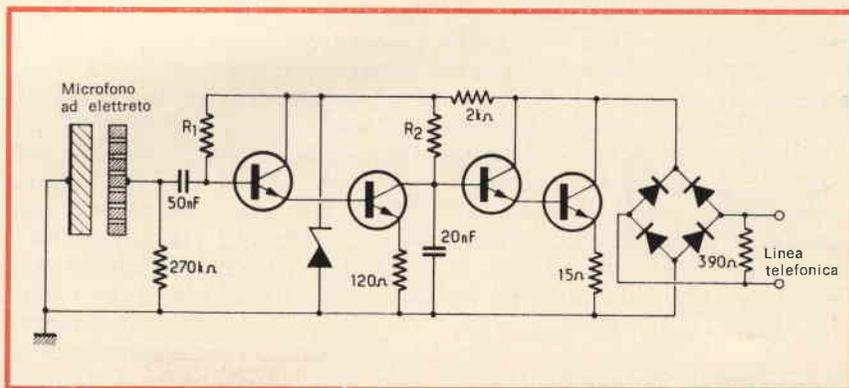
Fig. 7 - L'amplificatore, di cui il primo ed il terzo transistor sono riuniti in un solo contenitore, è a collegamenti diretti. Vi si nota la presenza di un diodo Zener stabilizzatore e di un ponte di diodi grazie al quale il senso di collegamento della linea telefonica è indifferente.
