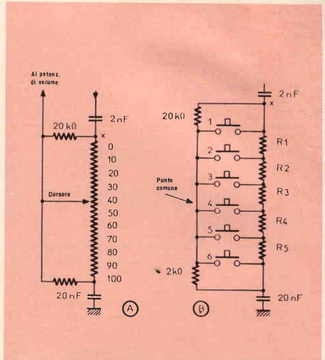
Fig. 15 - Confronto fra un circuito di tono a regolazione continua e uno a regolazione progressiva realizzato per mezzo di pulsanti.
