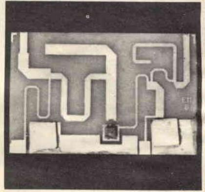
Fig. 5 - Amplificatore 2,25 GHz integrato; piastrina di 9,4 x 6,1 mm.
