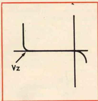
Fig. 3 - Grafico illustrante la curva caratteristica di un diodo zener. La freccia indica il gomito in corrispondenza del quale viene rilevato il valore di  $V_z$ , sul quadrante graduato della manopola che regola l'entità della deflessione orizzontale.
