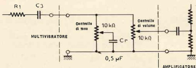
Fig. 13 - Circuito di tono a regolazione progressiva.
