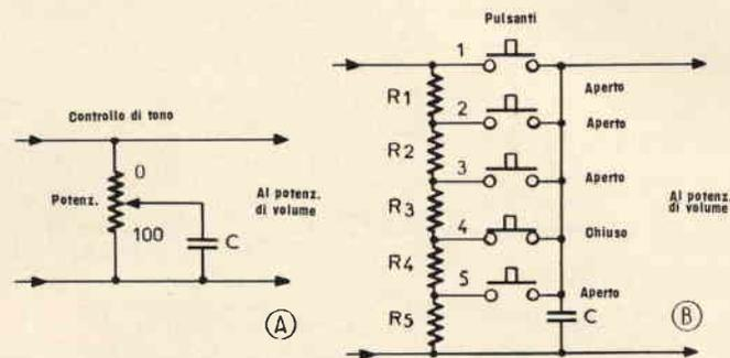
Fig. 14 - Circuito di tono a regolazione effettuata per mezzo di pulsanti.
