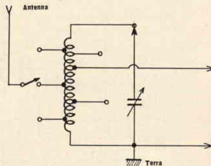
Fig. 3 - Sistema di spostamento della presa del catodo e del condensatore variabile per realizzare un ricevitore per onde medie e onde lunghe.
