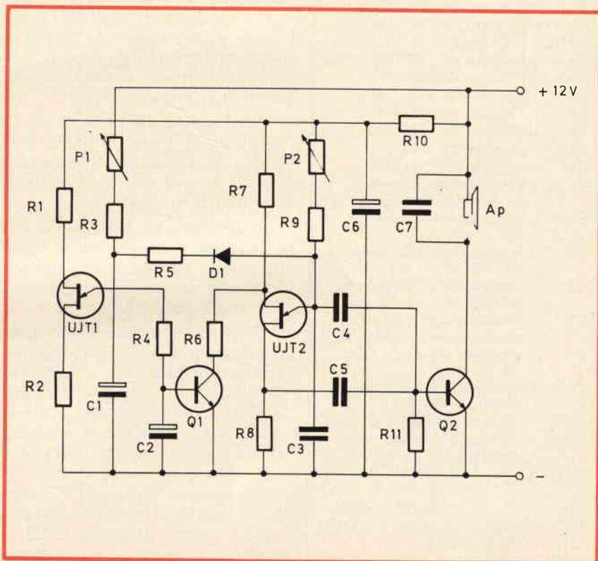
Fig. 2 - Schema elettrico del generatore di segnali che imita il suono di una sirena della polizia.
