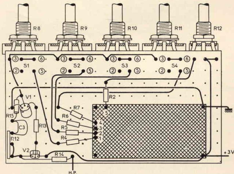
Fig. 3 - Altra vista del montaggio dei componenti.
